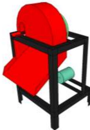
Gambar 1. Desain mesin perajang singkong
